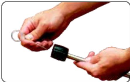
Caso não saia água do bico, ou o jato não esteja uniforme, desligue o equipamento, limpe o bico com a agulha que acompanha o equipamento.
