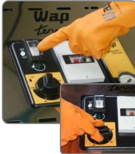
**12** Para aquecer a água acione o interruptor liga/desliga do queimador e regule a temperatura no botão de regulagem de temperatura.
