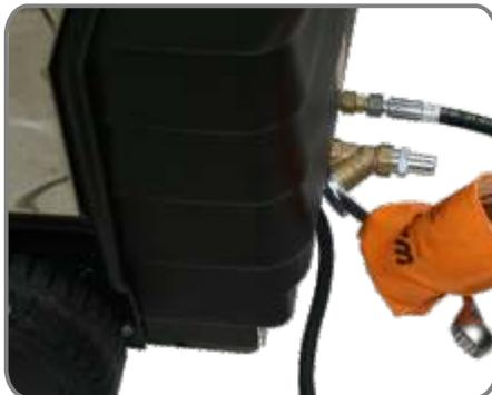
**1** Com o auxílio de uma chave n° 27 ou de um alicate retire a tampa do filtro. Retire o filtro, lave-o em água corrente ou troque-o se necessário, e recolque-o. Nunca opere o equipamento sem o filtro.
