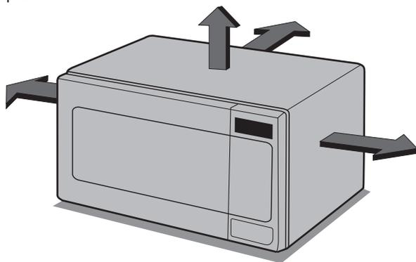
3. Ligue o forno microondas a uma tomada de três pontas. Não ligue mais nenhum eletrodoméstico a essa tomada.
