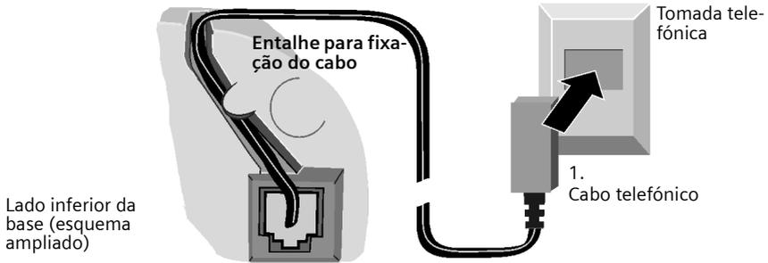
Lado inferior da base (esquema ampliado)
