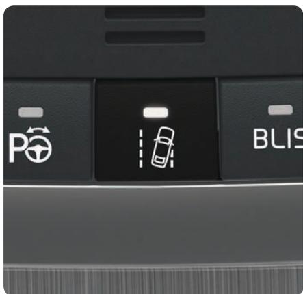
Se o automóvel estiver na iminência de cruzar uma linha lateral, a LKA actua no volante com um ligeiro binário para conduzir o automóvel de volta para a sua faixa. Se o automóvel cruzar uma linha lateral a LKA avisa o condutor com vibrações no volante.
