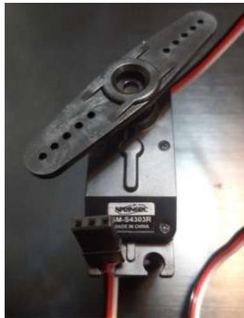
Figura 3.3 - Servo motor de rotação contínua (SM-S4303R)
