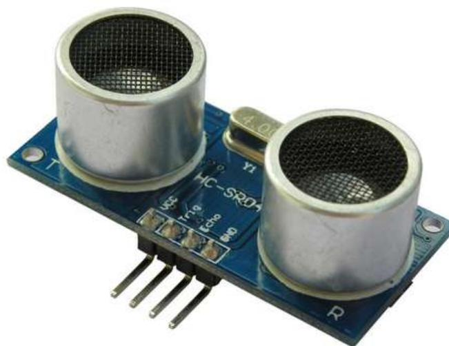
Figura 3.1 - Sensor Ultrassônico HC-SR04.
