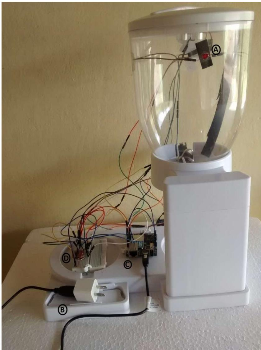
Figura 4.5 - (A) Led de alerta de nível de ração baixo no reservatório, (B) Fonte de alimentação do sistema, (C) Placa arduino e (D) protoboard com RTC acoplado.
