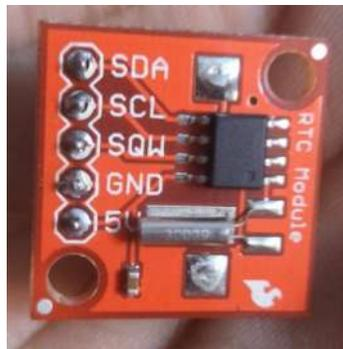
Figura 3.6 - Modulo RTC.
