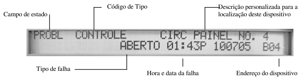
Figura 17 Modelo de Mensagem de um NAC em Falha
