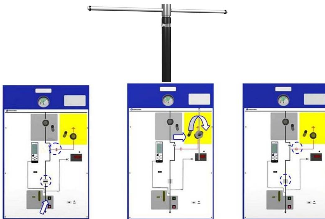
Figura 5.42: ligação à terra a partir do secionamento para o mecanismo A(M)V
