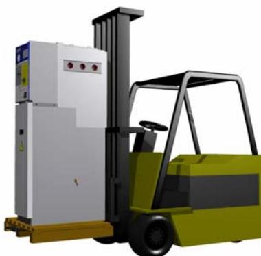
Figura 2.1: elevação de cela modular **cgm.3** através de uma empilhadeira
