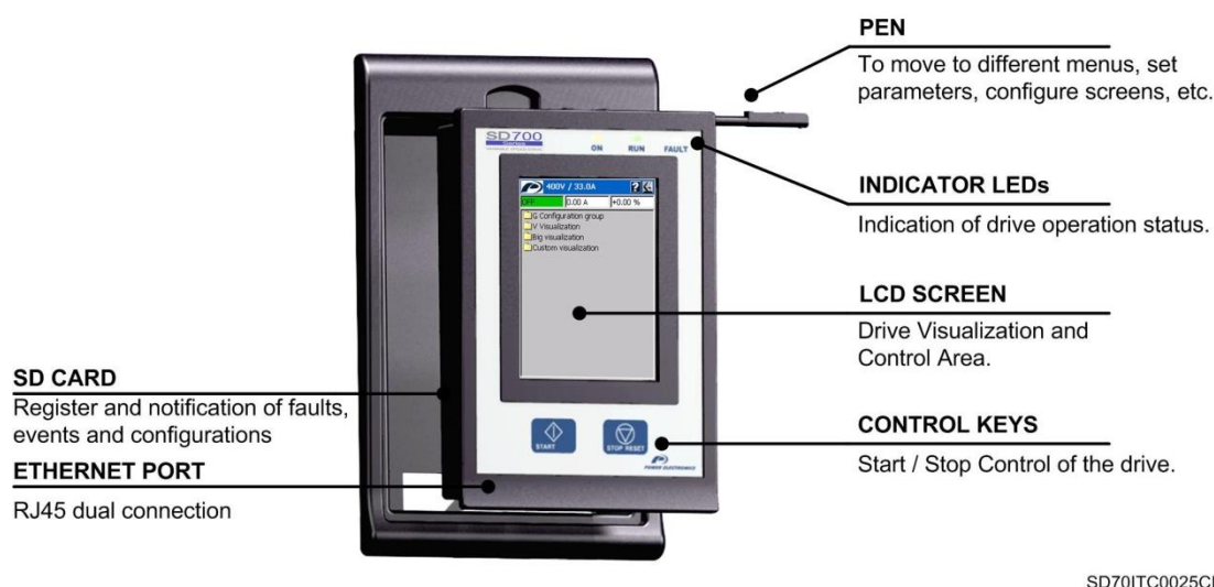
Figura 12.5 Unidade de painel gráfico Multi toque.
