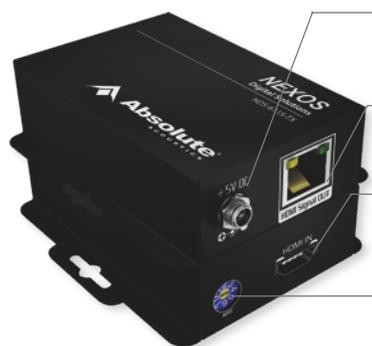
**DC In** - Conexão de entrada para fonte de alimentação elétrica.
