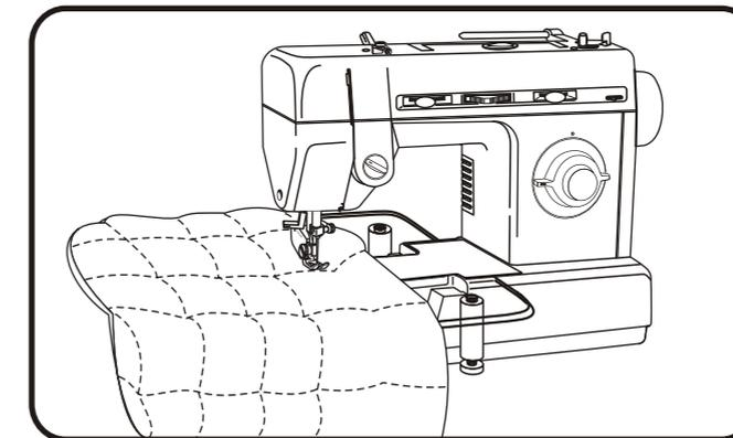
Para utilizar o acessório de costura circular, remova o retentor de tecido (1) e coloque a peça a ser costurada na agulha (2), prendendo-a novamente com o retentor de tecido. Através do rasgo (3) existente na mesa, ajuste o tamanho do círculo a ser feito, bastando para isto soltar a porca do acessório (4) existente na parte inferior da mesa e deslocá-lo para a direita ou para a esquerda, diminuindo ou aumentando o tamanho do círculo.
