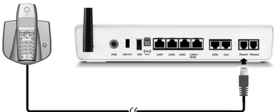
Cabo telefónico (a depender do país, faz parte do conteúdo da embalagem)
