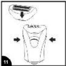
Reinstalar a tampa e fixá-la na parte superior do aparelho.
