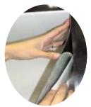
3. Alinhe a peça pelas laterais e fixe no móvel a parte que já está sem a proteção, pressionando-a contra o móvel
