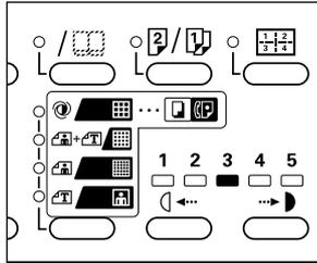
\* Se quiser alterar a resolução, pressione a tecla de seleção da resolução até acender o indicador de resolução correspondente à resolução pretendida.
