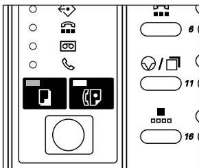
Para comutar para o modo de funcionamento como fax, pressione a tecla de CÓPIA/FAX. Quando o aparelho está em modo de funcionamento como fax, a lâmpada da tecla de FAX estará acesa e aparece no visor de cristal líquido uma mensagem distintiva deste modo.
