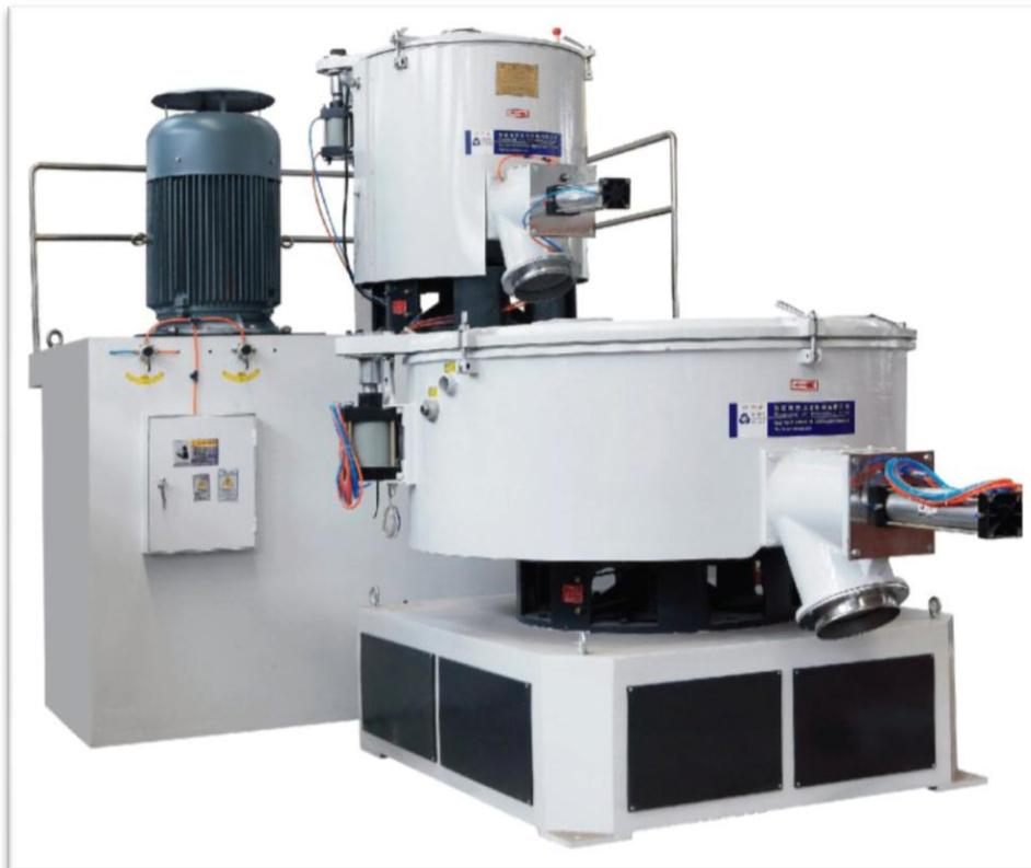
Figura 1 - Misturadora vertical SRL-Z
