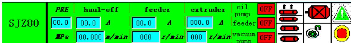
Este menu, presente em todas as telas de operação, permite a verificação da velocidade da extrusora e do alimentador, da corrente, do estado de funcionamento da bomba de vácuo e de óleo e dos motores da extrusora e do alimentador.
