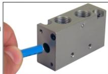
6 - Limpe o corpo da válvula com ar comprimido;
