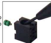
5 - Limpe com ar comprimido afim de desentupir os orifícios pneumáticos;
