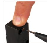
2 - Verifique os componentes internos, caso estejam em boas condições, lubrifique-os com graxa alimentícia, caso contrário, substitua-os por novos, já lubrificados de fábrica;
