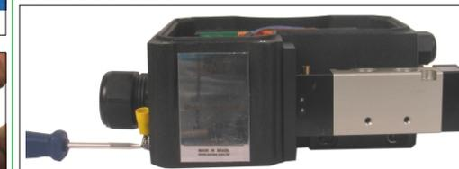
5° - coloque os outros parafusos que prendem a válvula ao invólucro do atuador.
