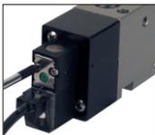
2 - Desmonte o corpo pneumático, soltando quatro parafusos (dois de cada lado);
