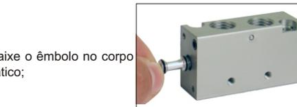
4 - Encaixe o êmbolo no corpo pneumático;
