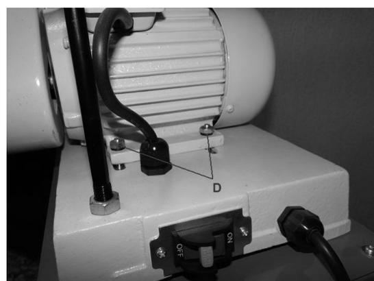
7. Uma vez que a correia foi removida, reposicione a uma nova correia tipo V idêntica ao redor da polia na parte traseira do disco de alumínio e reinstale o disco no eixo. Fixe a tampa da rosca novamente no lugar.
