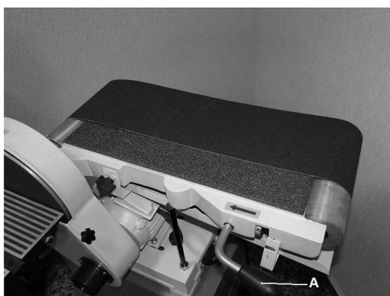
5. Coloque a lixa nova e alinhe-a no centro de cada eixo e tencione a lixa girando a alavanca (A) da figura acima no sentido anti-horário.
