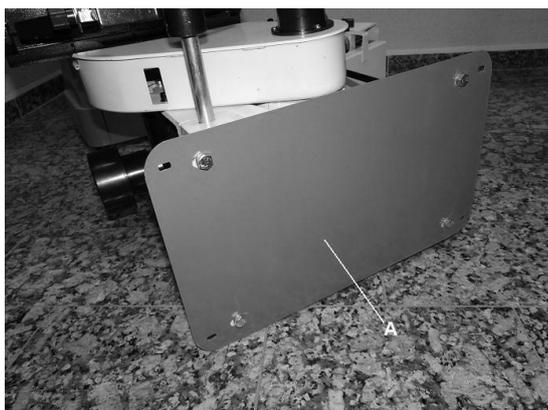
7. Posicione a unidade principal sobre o gabinete, alinhando os furos para a fixação dos 4 parafusos Phillips (veja a figura seguinte).
