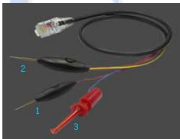
Figura 17 – Adaptador de Ponto de Teste 1 – Adaptador Ponto de Teste E-GOLD 2 - Adaptador Ponto de Teste S-GOLD/E-GOLD 3 – ALIMENTÇÃO DO APARELHO (3,6v+)
