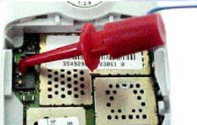
Figura 63 - Conecte a ponta de prova de alimentação no positivo do aparelho
