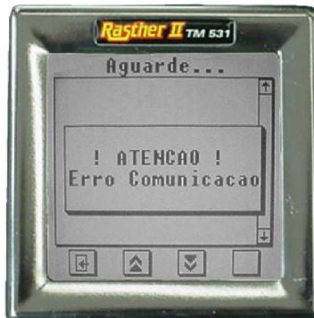
Aperte uma tecla qualquer e repita a operação. Se o problema persistir, desligue o Rasther e verifique se as ligações dos cabos estão corretas ou se existe algum problema nos cabos e conectores. Siga corretamente a seqüência de ligação e tente novamente.
