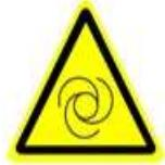
No caso de ventiladores eléctricos existe o risco de, com o motor parado e a ignição desligada, o ventilador entrar inesperadamente em funcionamento.
