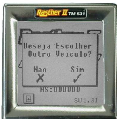
Se for digitado "SIM" o Rasther apaga os códigos de falha do teste anterior e permite a escolha de outro veículo.
