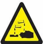
**Os ácidos e as soluções alcalinas** podem corroer seriamente a pele desprotegida. O fluoreto de hidrogénio, juntamente com a humidade (água), forma o ácido fluorídrico. **A água decondensação** que se acumula na mangueira de recolha de gases de escape e no recipiente de condensado também contém ácido.
