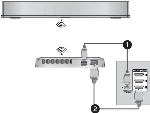
2. Conecte o cabo HDMI à TV e ao CONTROLADOR WIRELESS.
