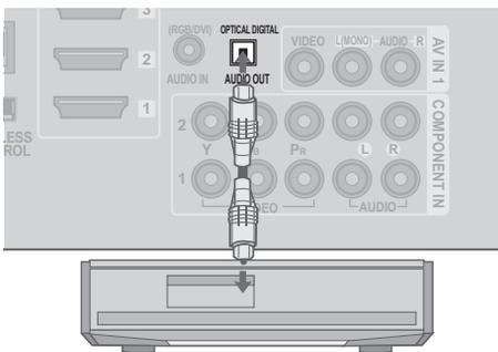
1. Conecte o cabo ótico na conexão **OPTICAL DIGITAL AUDIO OUT** da TV, em
