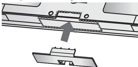
Ao remover a base, para evitar o contato com as partes metálicas do aparelho, instale imediatamente a **TAMPA DE PROTEÇÃO** (fornecida). Posicione corretamente a tampa e pressione-a levemente (ao ouvir um clique) para encaixá-la.
