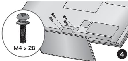
2. Encaixe o **SUPORTE** à **BASE** usando os parafusos fornecidos, após fixar o suporte, instale o **ORGANIZADOR DE CABOS**.
