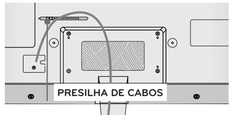
2. Ao finalizar a instalação dos cabos organize-os usando a **PRESILHA DE CABOS** (não fornecida).
