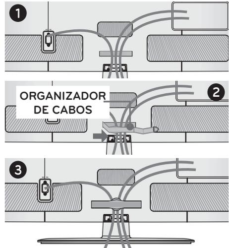
1. Ao finalizar a instalação dos cabos organize-os usando o **ORGANIZADOR DE CABOS**.
