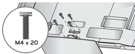
5. Após fixar os parafusos, melhore a apresentação do produto instalando o **PROTETOR TRASEIRO** na base conforme ilustração.
