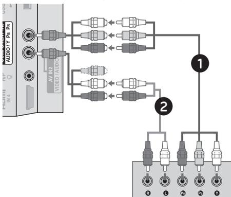
Conecte os cabos **P2** às entradas **COMPONENT IN 3 (VIDEO - Y, PB, PR e ÁUDIO - VERMELHO e BRANCO)** da TV. Após conectar os cabos na TV efetue a conexão do equipamento externo.
