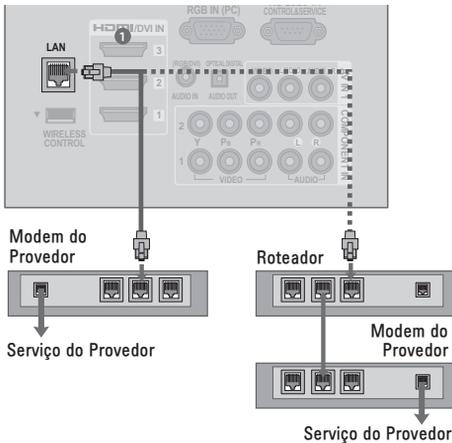
1. Para efetuar a correta conexão tenha em mãos um cabo de rede (RJ-45 - não fornecido). Conecte-o à porta LAN da TV e ao seu roteador/modem.
