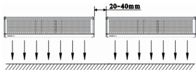
3.5 Não deixe espaço entre a Cortina de ar e a parede. Quando pendurar a unidade no teto, use suportes de teto extra.
