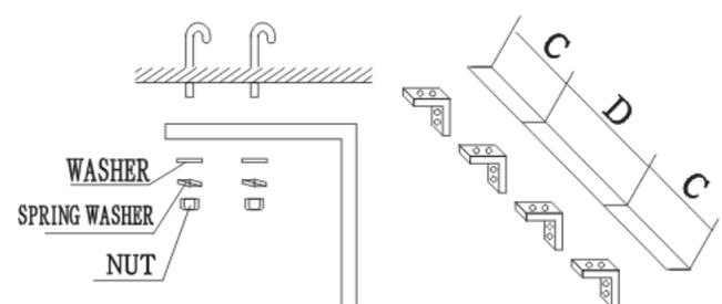
4.3.3 Fixe a placa de suporte nas alças instaladas. Deixe uma margem de segurança de 10cm na ponta da alça.
