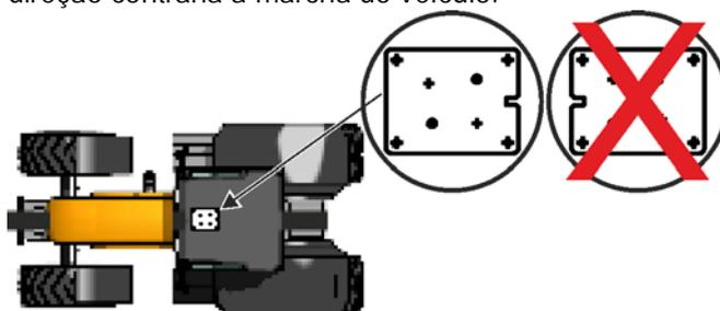
4. Coloque o receptor GPS sobre a placa magnética de modo que ele encaixe. A conexão deve apontar na direção contrária à marcha do veículo.
