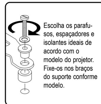
Escolha os parafusos, espaçadores e isolantes ideais de acordo com o modelo do projetor. Fixe-os nos braços do suporte conforme modelo.
