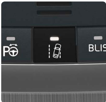
Se o automóvel estiver na iminência de cruzar uma linha lateral, o LKA actua no volante com um ligeiro binário para conduzir o automóvel de volta para a sua faixa. Se o automóvel cruzar uma linha lateral o LKA avisa o condutor com vibrações no volante.
