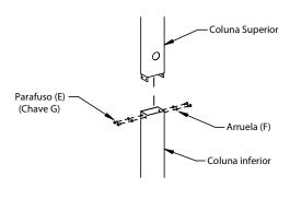
**Passo 4:** Instale a bandeja travando-a com a abraçadeira na coluna, utilizando os parafusos (E) e arruelas (F). Aperte com a chave Allen (G).
