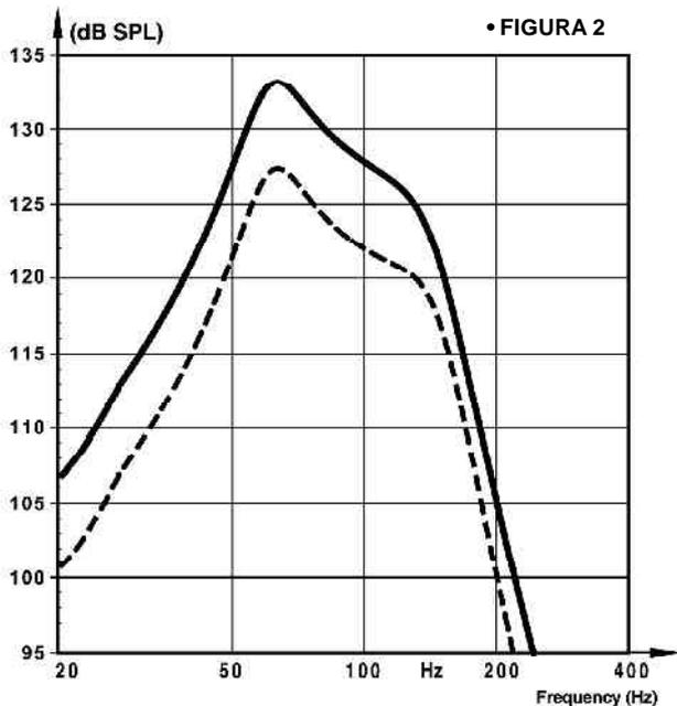
Curvas de resposta de frequência da caixa acústica **SUB 18.40**, quando conectada no sistema ativo de subwoofer **SUB 600 A / SUB 600 A - 2G**, ou recebendo amplificação externa alternativa específica de subwoofer, nas condições estabelecidas nos “Pré-requisitos Técnicos”, páginas 2 e 3.
