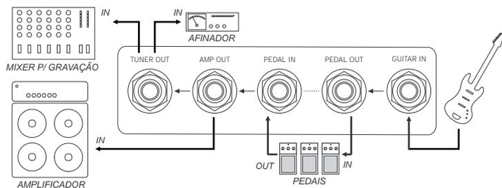
A chave LIFT/GND isola eletricamente a fonte de alimentação do painel de conexões. Eventuais ruídos causados por "ground looping" poderão ser resolvidos passando-a para a posição LIFT.
