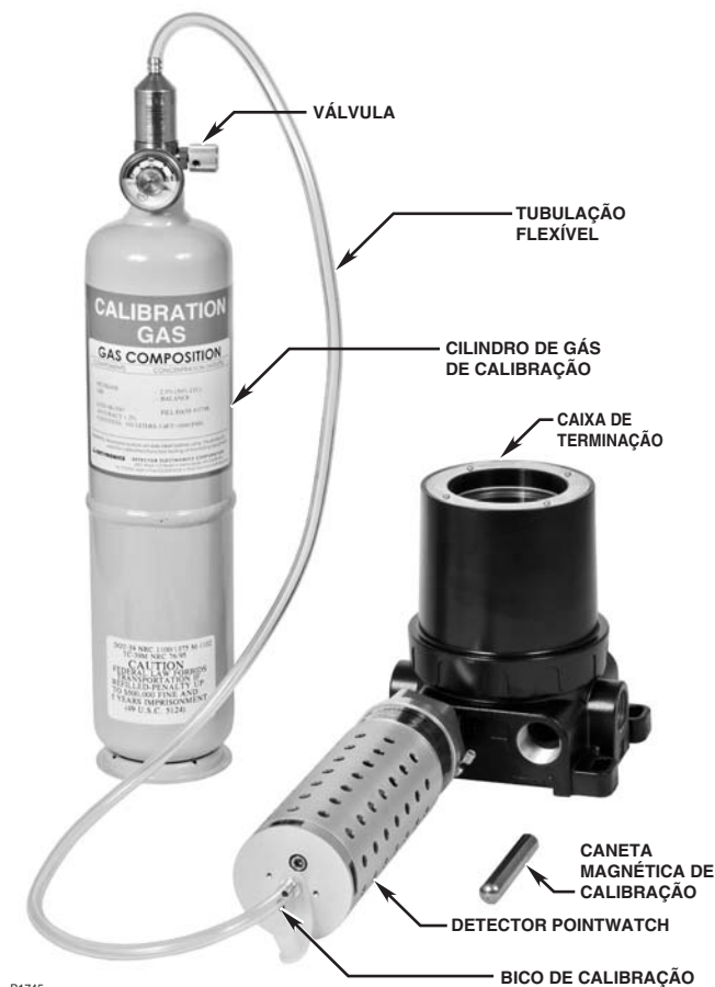
Figura 24 — Configuração de calibração do detector PIR9400 de alumínio
