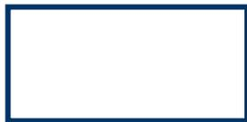
**Processamento** - usado para operações de manipulação dos dados ou operações aritméticas
