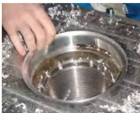
Chanfragem de diâmetro 250 passo 6.
