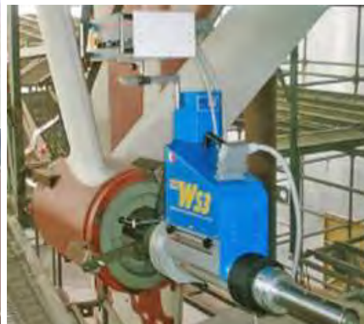
Recuperação de barbatanas estabilizadoras de um navio.
