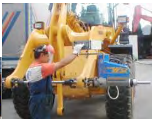
Reacondicionamiento e realinhamento de orifícios, braços e carregadoras com rodas.
