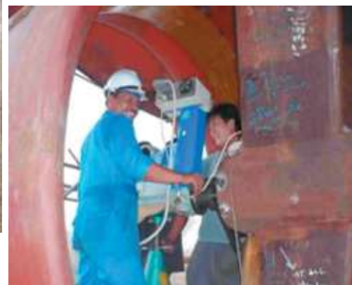
Enchimento de soldadura em diâmetros de 1460mm com tochas especiais refrigeradas a água.
