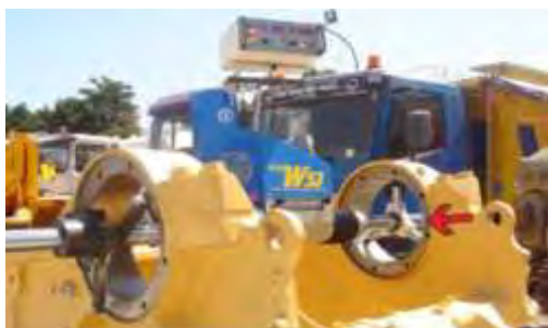
Recondicionamiento do alojamento de buchas Crusher 420mm com uso suporte de expansão autocentrante.
