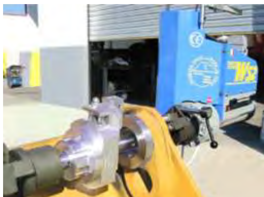
Reacondicionamiento e realinhamento de orifícios, braços e carregadoras com rodas.
