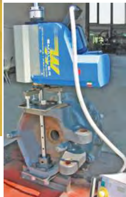
Renovação do alojamento do eixo rotativo.
