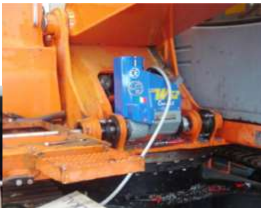
Restauração suporte para os cilindros, elevação do braço das escavadoras sem retirar a cabine. Nas novas máquinas, desmontar a cabine em fase de rastreio, pode trazer complicações graves sobre os aparelhos eléctricos e electrónicos.
