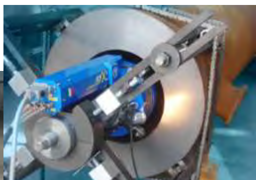
Suporte autocentrado com expansão pneumática.
