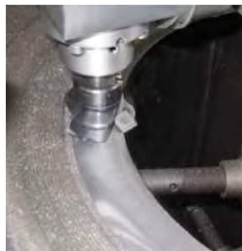
Criação de alojamento para guarnição (cortadores com lâmina de 60 mm).
