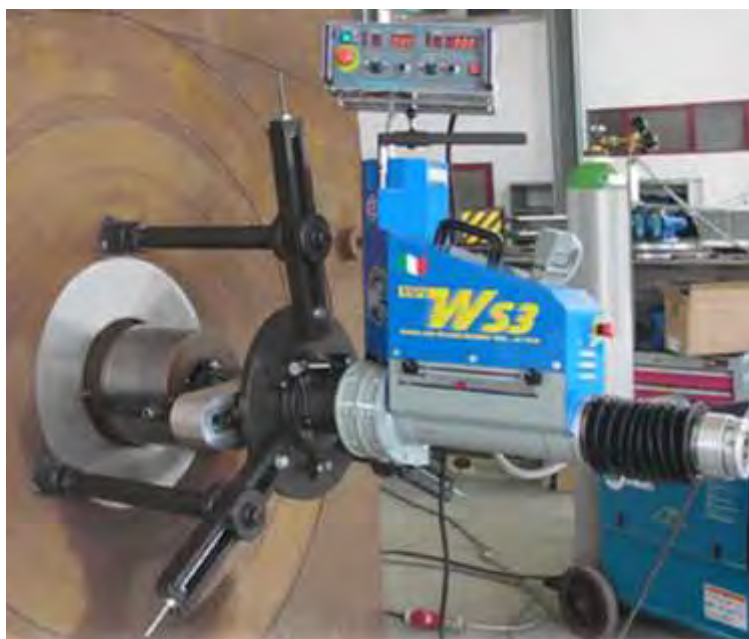
Maquinagem externa de parafusos de fundição Ø 320mm e comprimento 280mm.
