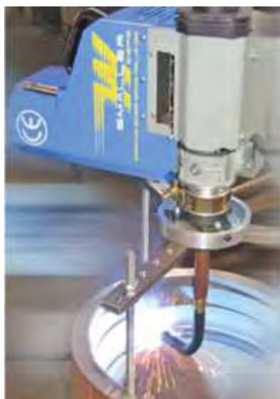
Enchimento por soldadura até Ø 380mm.
