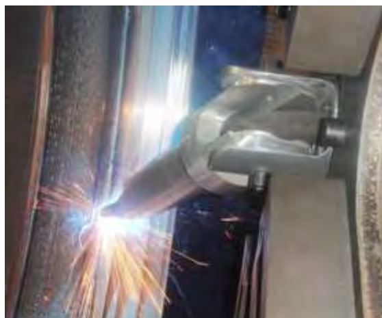
Enchimento de soldadura em diâmetros de 1460mm com tochas especiais refrigeradas a água.
