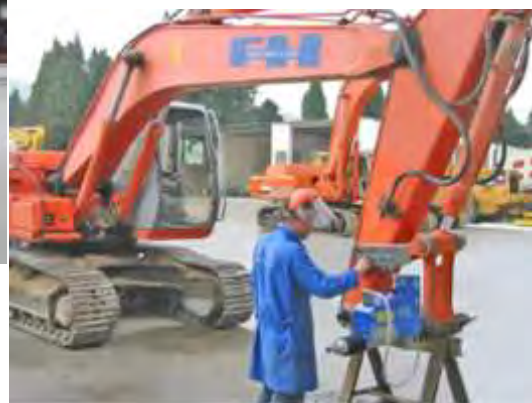
Reacondicionamiento e realinhamento de orifícios, braços e carregadoras com rodas.
