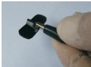
2) Encaixe a garra no orifício do eletrodo de silicone, entre a parte interna e externa.
