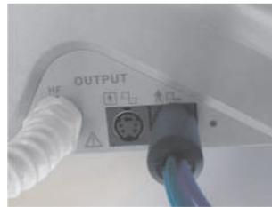
7) Cabo conectado na saída para correntes polarizadas microcorrentes, iontoforese, iontoforese OFF, desincruste, lifting e microgalvanopuntura.
