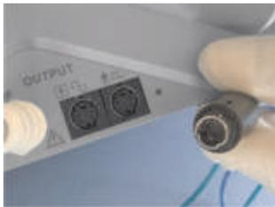
5) Conecte o cabo de aplicação na saída do equipamento, verificando o posicionamento correto do conector.
