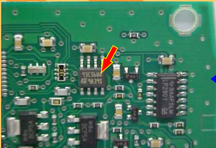
Ilustração mais detalhada da memória SMD 93C56 na Placa De Circuito do Imobilizador P8200900862K
