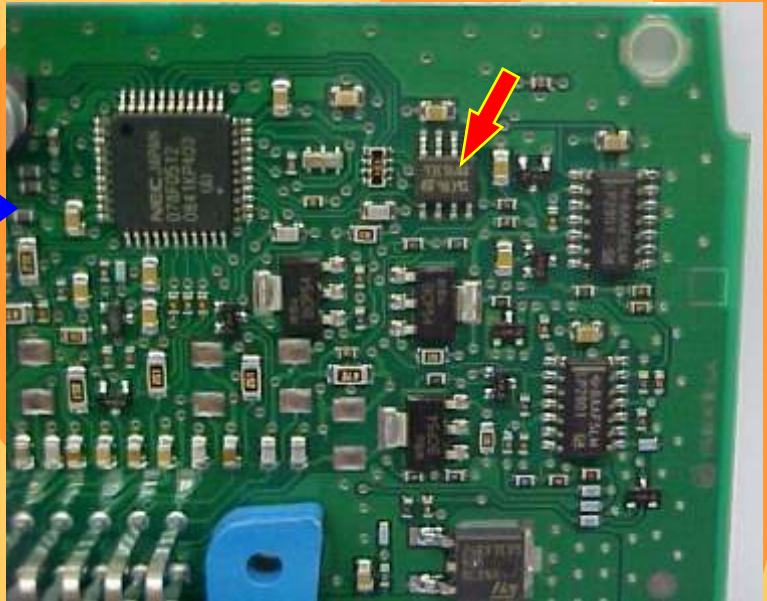
Localização da Memória SMD 93C56 na Placa De Circuito do Imobilizador P8200900862K
