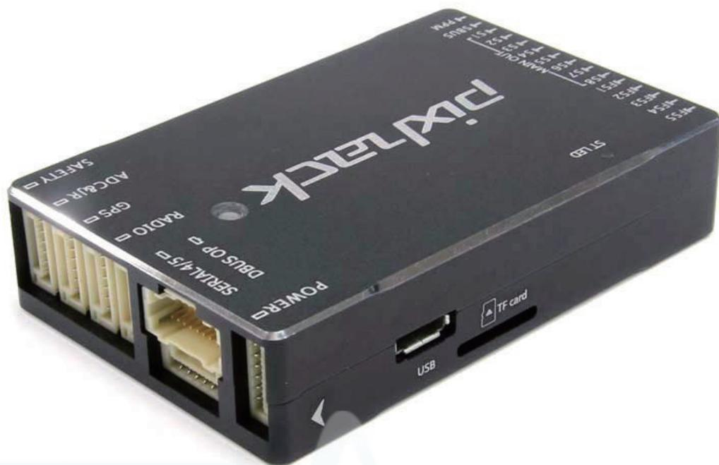
Com uma melhor estabilidade e anti-interferência, Pixhack é uma versão atualizada desenvolvida pela CUAV, com hardware básico igual ao do pixhawk. Pixhack é compatível com hardware de APM 3DR e pixhawk. O fabricante atualizou a potência do chip, acrescentando amortecimento para IMU e ajustou as portas de conexões.
