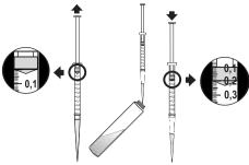
Nota: Para medir exactamente 0.2 ml. de amostra com a seringa, empurre o embolo da seringa completamente para dentro e insira a extremidade na amostra. Puxe o embolo para fora até que o vedante esteja na marca 0.0 ml. da seringa. Insira a seringa na cuvete e empurre a amostra para fora até que o vedante esteja na marca 0.2 ml.
