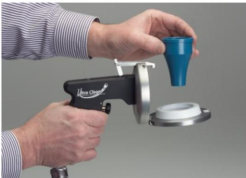
Abra a placa frontal do lançador CE/UC pressionando a barra de segurança com o polegar da mão que segura o lançador.
