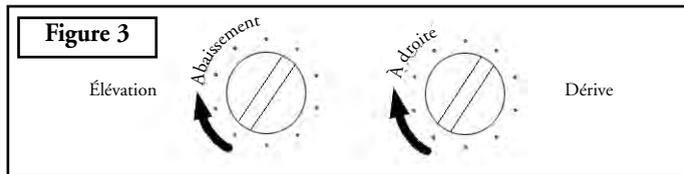
Pour déplacer le point d'impact vers la DROITE, tourner la vis de réglage dans le sens horaire, pour le déplacer vers la GAUCHE, tourner la vis dans le sens antihoraire.
