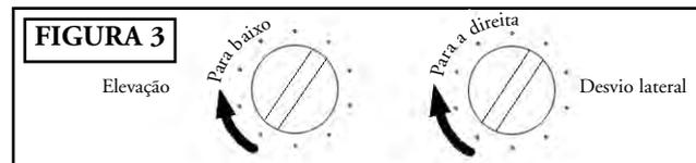
Para mover o ponto de impacto PARA A DIREITA, gire o parafuso de ajuste no sentido horário; para movê-lo para a ESQUERDA, gire o parafuso no sentido anti-horário.
