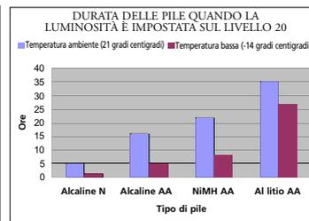
**SOSTITUZIONE DELLE PILE**
