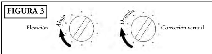
Para mover el punto de impacto a la DERECHA, gire el tornillo de ajuste a la derecha; para mover el punto de impacto a la IZQUIERDA, gire el tornillo de ajuste a la izquierda.
