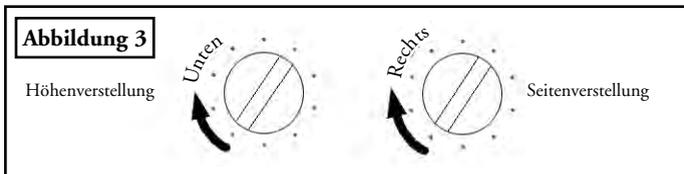
Um den Aufprallpunkt nach RECHTS zu bewegen, muss die Einstellungsschraube im Uhrzeigersinn, um ihn nach LINKS zu bewegen, gegen den Uhrzeigersinn gedreht werden.
