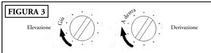
Per spostare il punto di impatto a DESTRA o a SINISTRA, girate la vite micrometrica della derivazione rispettivamente in senso orario o in senso antiorario
