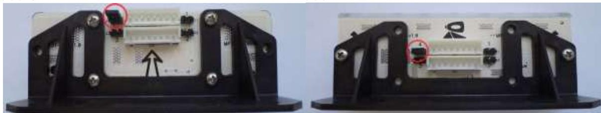
Figura 22 - Jumper na posição 4 (blocos 6, 10 e 11)
