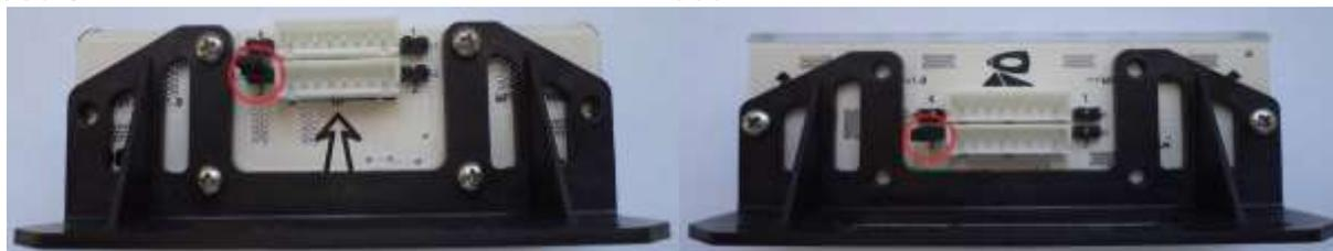
Figura 21 - Jumper na posição 3 (blocos 5 e 12)
