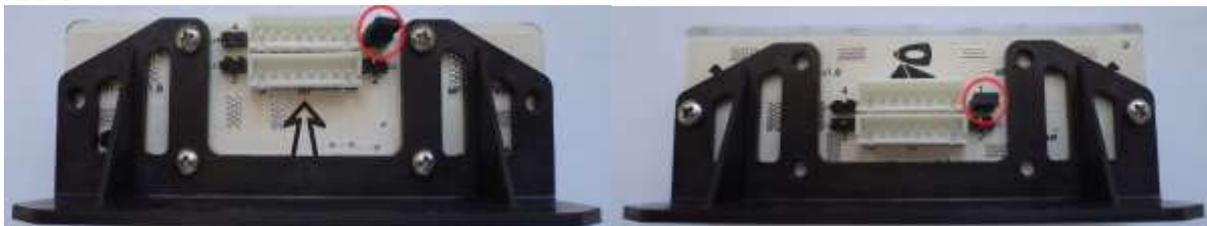
Figura 19 - Jumper na posição 1 (blocos 1, 2, 3, 7, 8 e 9)
