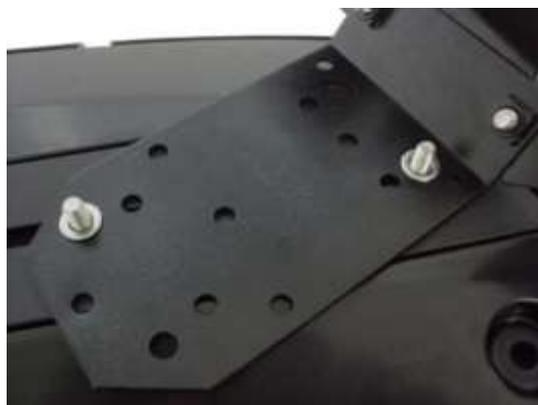
**Figura 7 - Encaixe do alongador nos parafusos**
