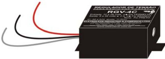
O regulador de tensão RGV-4C é constituído por uma fonte chaveada que mantém a tensão de saída estabilizada dentro do valor previamente regulado. Seu funcionamento correto ocorre com o motor da aeronave em funcionamento. Com o motor desligado, pode aparecer no visor do rádio VHF o aviso de bateria fraca durante a transmissão.
