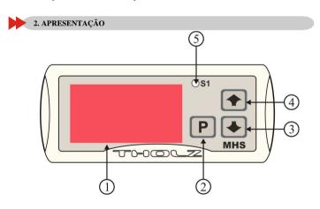
1-Display - indica normalmente a temperatura do reservatório. Quando em programação indica o mnemônico do parâmetro ou valor a ser programado.
