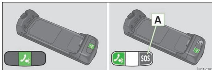
Fig. 131 Esquema de princípio: adaptador com um botão / adaptador com dois botões
