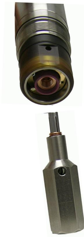
3. Aperte o conjunto do eléctrodo para a direita, atarraxando-o ao corpo da tocha. O eléctrodo fica apertado na posição correcta quando a pinça de fixação se fecha.
