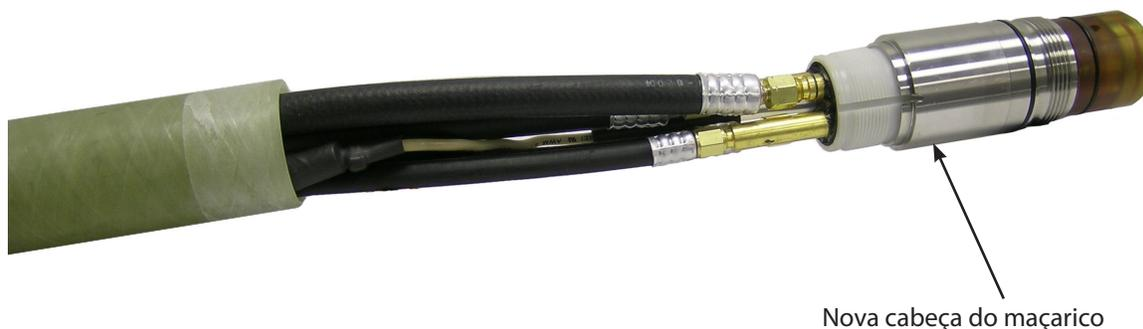
5. Faça deslizar o punho para a frente e enrosque-o firmemente no corpo do maçarico.
