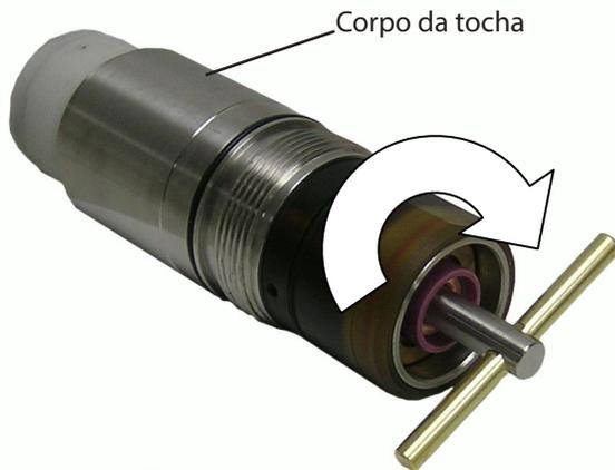
1. Volte a colocar o suporte do eléctrodo no corpo da tocha. A chave sextavada na extremidade da ferramenta de remoção do suporte do eléctrodo encaixa na cabeça sextavada do suporte.
