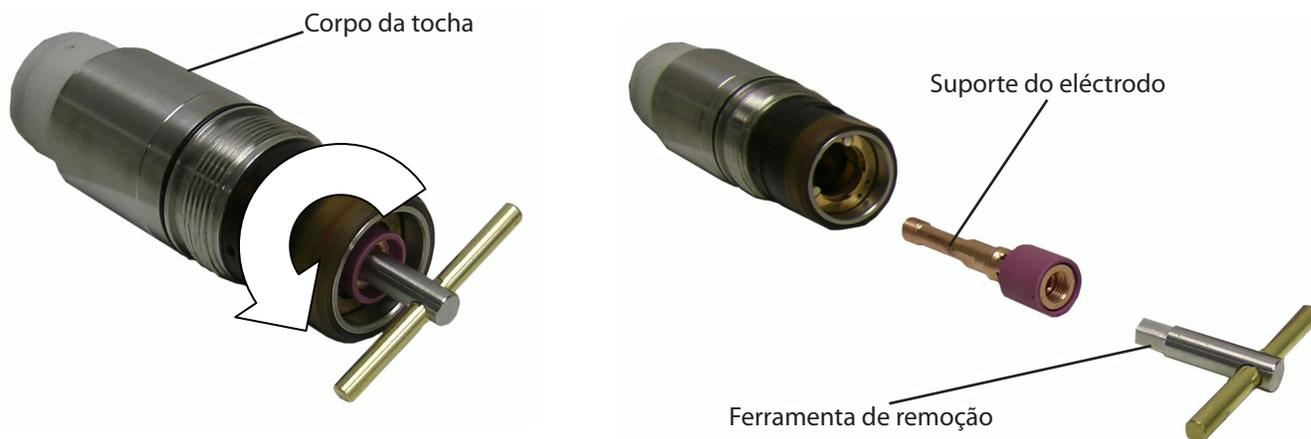
8. Desmonte o suporte do eléctrodo e o difusor de gás. Remova cuidadosamente o anel O-ring do suporte do eléctrodo e retire o difusor do suporte. Verifique se a superfície de assentamento do bico (extremidade dianteira) apresenta fendas. Procure fissuras ou orifícios tapados. Não tente desobstruir os orifícios. Substitua o difusor, caso se encontre danificado.
