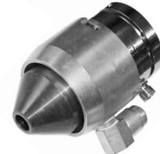
Cortina de ar (dispositivo utilizado para melhorar o desempenho do Maçarico de Corte de Arco de Plasma PT-36 ao corte debaixo de água. O dispositivo instala-se no maçarico e produz uma cortina de ar. Desta forma, permite que o arco de plasma funcione numa área relativamente seca, mesmo que o maçarico esteja submerso para reduzir os níveis de ruído, gases e radiação do arco).....37440
