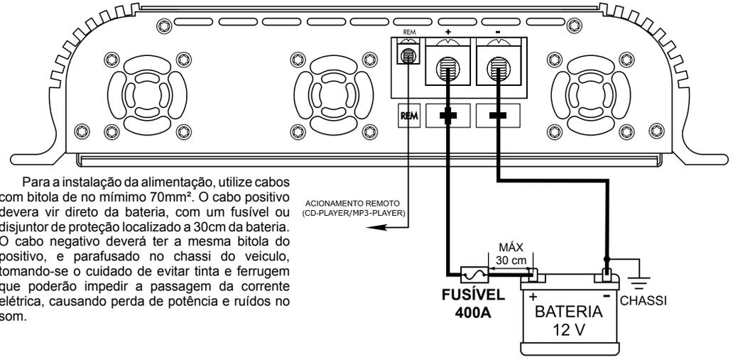
Para a instalação da alimentação, utilize cabos com bitola de no mínimo 70mm<sup>2</sup>. O cabo positivo deverá vir direto da bateria, com um fusível ou disjuntor de proteção localizado a 30cm da bateria. O cabo negativo deverá ter a mesma bitola do positivo, e parafusado no chassi do veículo, tomando-se o cuidado de evitar tinta e ferrugem que poderão impedir a passagem da corrente elétrica, causando perda de potência e ruídos no som.
