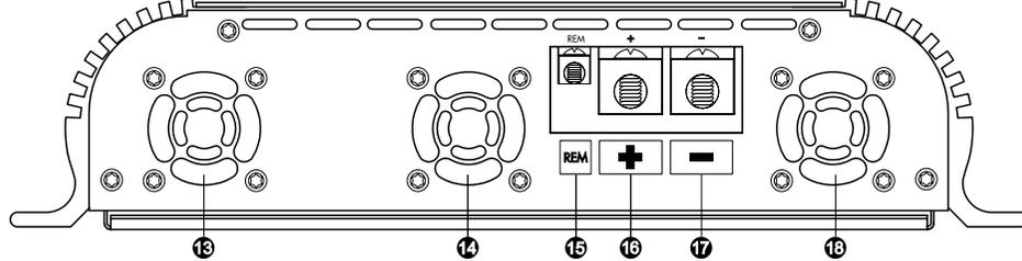
1/12) **VENTILAÇÃO:** Permite a saída do ar aquecido do amplificador.
