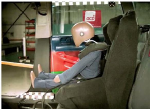
Aos 92 milésimos de segundo a cabeça alcança o seu movimento máximo sem superar o avance máximo de proteção contra a qualquer impacto contra elementos do interior do veículo. A cadeira continua corretamente instalada:
