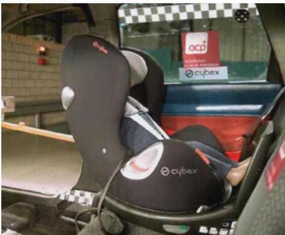
Desde o milésimo de segundo 46 até ao 74 produz-se a deformação do chão do veículo na zona de fixação do pé de apoio. Neste intervalo de tempo produz-se a máxima aceleração da cabeça (42.7g no milésimo de segundo 74) e de peito (36.1g no milésimo de segundo 67) do ocupante em posição vertical. A deformação do chão do veículo e da espuma do assento afeta a velocidade de movimento da cadeira e do ocupante:
