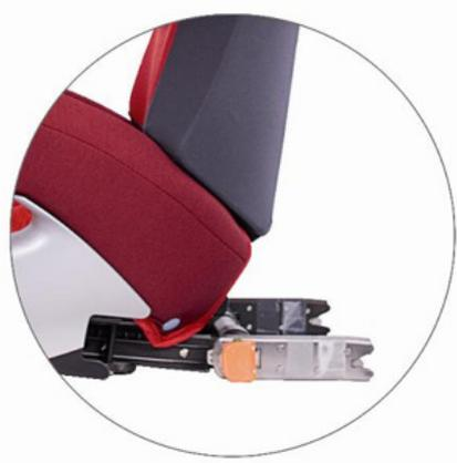
O sistema ISOFIX consiste num sistema de fixação da cadeira ao veículo, composto por três pontos de fixação ou apoio: dois situados na parte inferior do assento do automóvel e um terceiro ponto de fixação na parte traseira do assento (chamado Top Thether) ou mediante um pé de apoio que vai desde a cadeira até ao chão do veículo.
