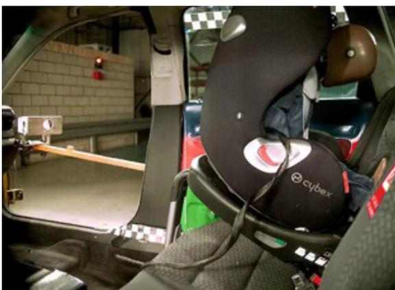
O conjunto começa a fase de retrocedimento à parte traseira do veículo. Os níveis de aceleração medidos durante o retrocedimento não são importantes, apesar do acentuado movimento da cadeira durante esta fase. Ainda assim continua sem haver qualquer tipo de risco de projeção do ocupante.
