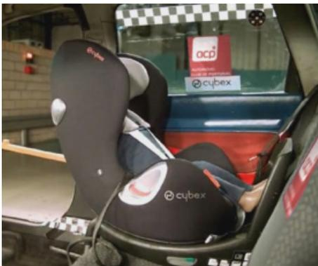
Neste instante a aceleração da carroceria alcança o nível máximo e a criança mantém-se dentro do sistema de retenção, mas este começa já a movimentar-se para a frente do veículo:
