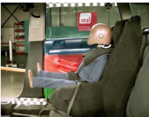
Desde o milésimo de segundo 46 até ao 74 produz-se a deformação do chão do veículo onde está instalado o pé de apoio. Neste intervalo de tempo produz-se a aceleração máxima da cabeça (42.7 g no milésimo de segundo 74) e de peito (36.1 g no milésimo de segundo 67) do ocupante em posição vertical. O movimento de cabeça e peito do manequim é mais suave:
