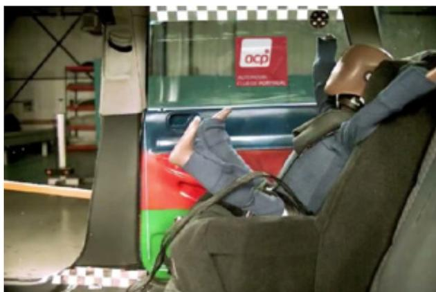
O manequim de um ano e meio finaliza o movimento corretamente sentado dentro do sistema de retenção que continua ancorado ao automóvel após o impacto:
