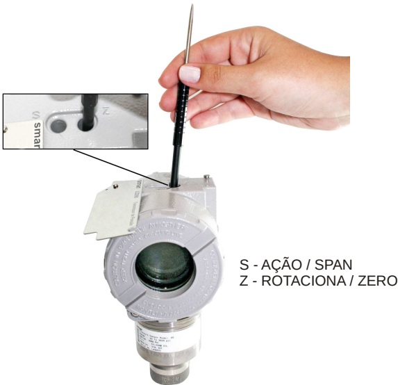
Figura 3.1 – Ajuste Local de Zero e Span e Chaves de Ajuste local
