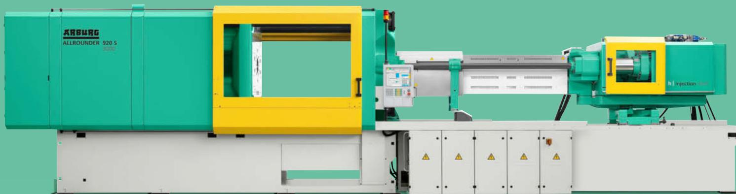
**Distâncias entre colunas de 170 x 170 até 920 x 920 mm | Forças de fechamento de 125 a 5.000 kN | Unidades injetoras de 30 até 4.600 (conforme EUROMAP) | Injetoras elétricas, híbridas, hidráulicas e verticais**
