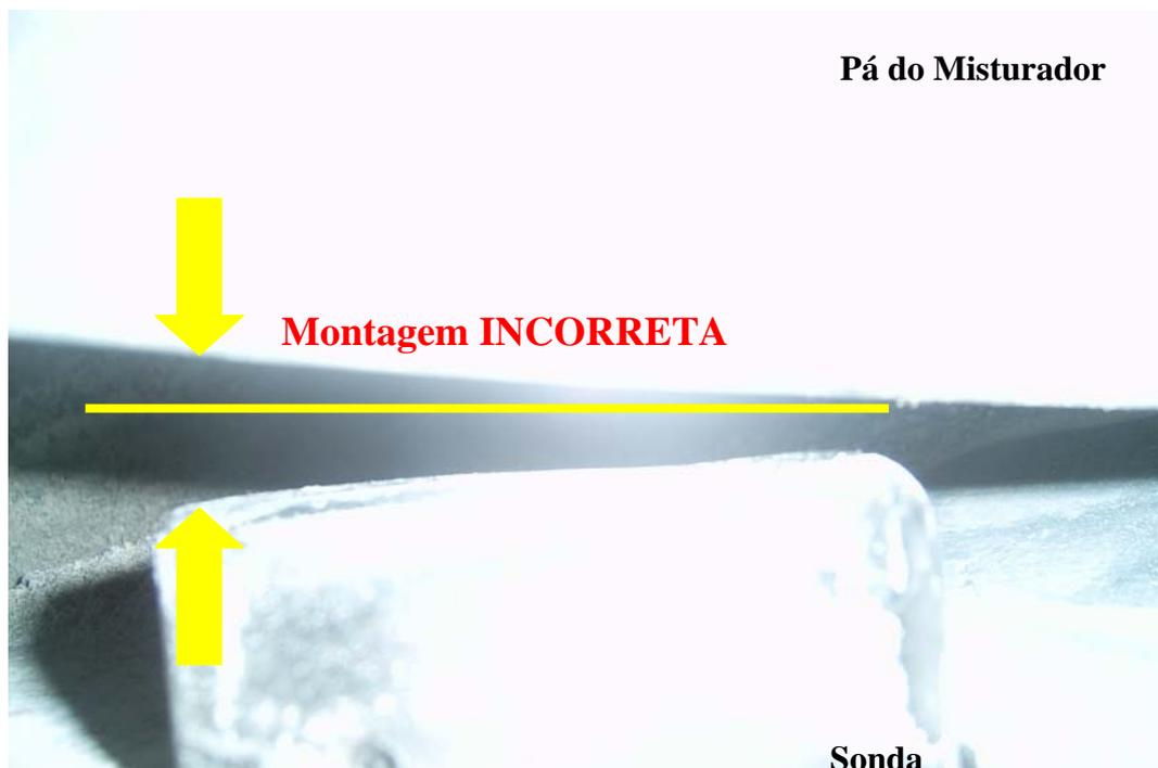
Foto 15 - Não há paralelismo entre a face da sonda e a pá do misturador. Isto acarreta acúmulo de massa sobre a sonda e erro na leitura da umidade (ver foto 16).
