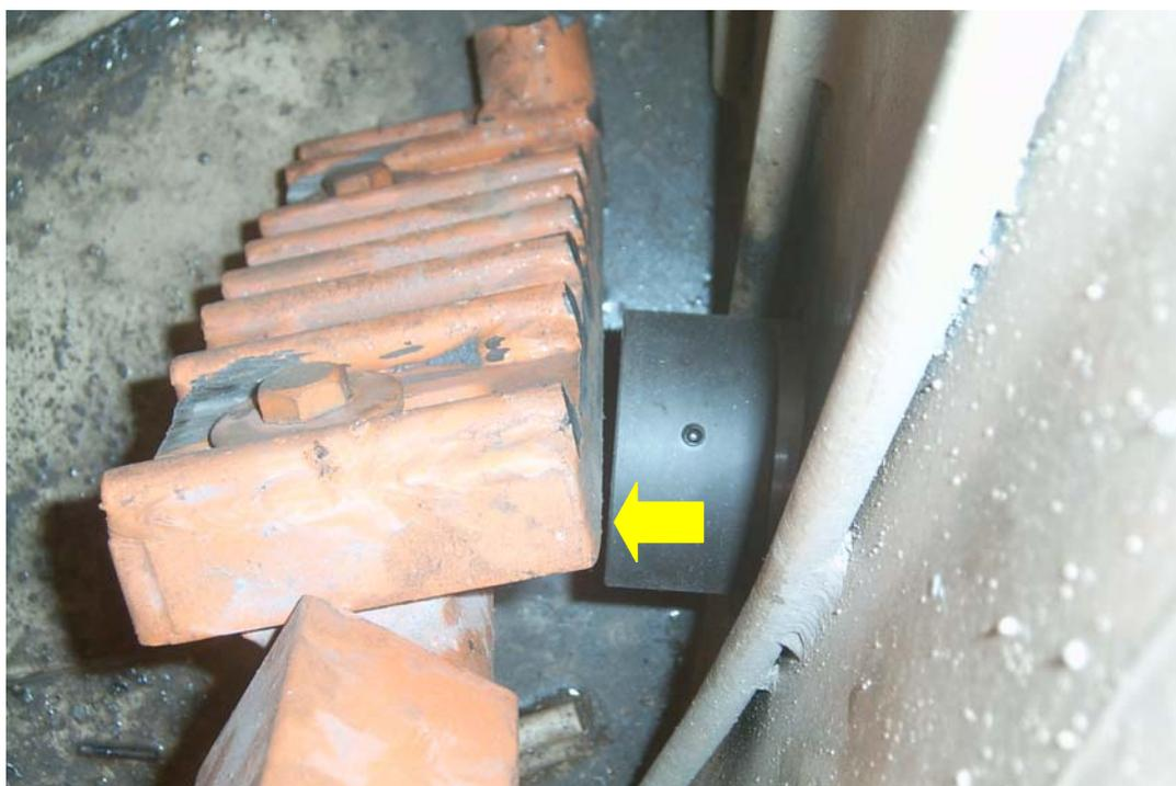
Foto 14 - Observar que mesmo montado na lateral, a distância entre a pá raspadora e a face do sensor deve obedecer os mesmos 5 a 10 mm como no misturador de eixo horizontal. Também é importante o paralelismo entre a pá e a face do sensor de modo a garantir a limpeza da sonda e a renovação de massa durante a mistura.
