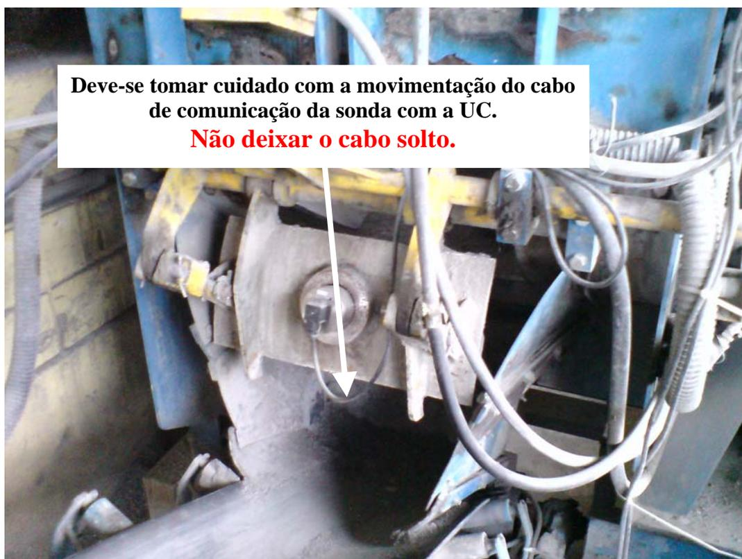
Foto 4 - Vista externa da montagem da sonda na comporta de descarga.
