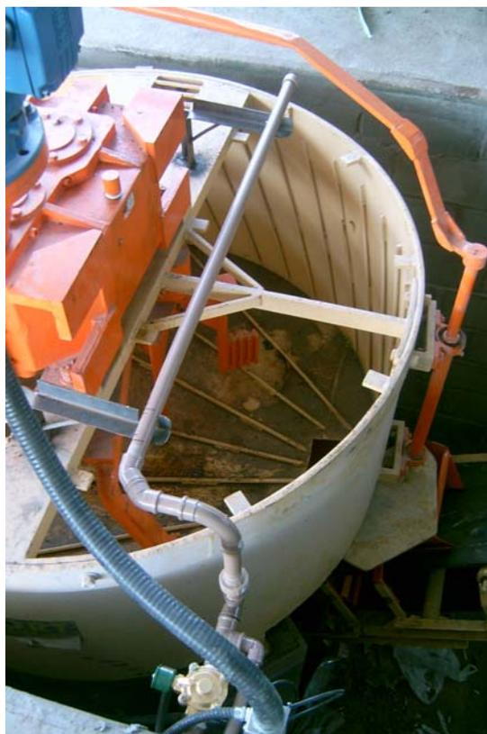
Foto 19 - Montagem correta de “chuveirinho” em misturador de eixo vertical
