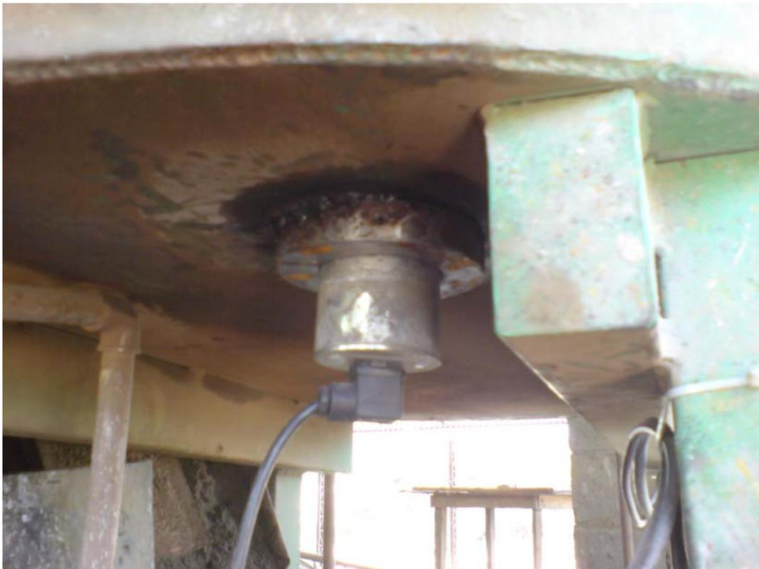
Foto 09 - Vista externa da montagem da sonda no fundo de misturador de eixo vertical.
