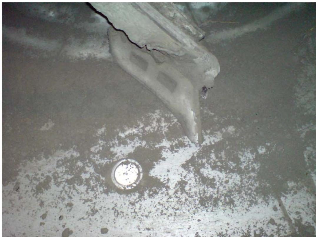
Foto 08 - Vista de sonda montada no fundo de misturador de eixo vertical. A distância entre o centro da sonda e a parede lateral do misturador de ser igual a  $1/3$  do raio. Posicionar a sonda de modo que o pá passe sobre o sensor proporcionando a limpeza da face da sonda e a renovação de massa durante a mistura.
