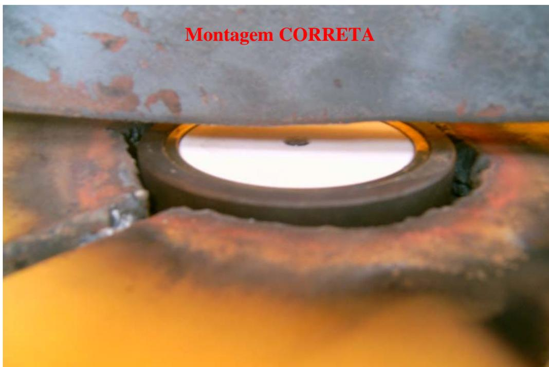
Foto 13 - Montagem correta da sonda. Face da sonda paralela à pá. Neste caso, como trata-se de um misturador novo a sonda é montada na condição ideal, faceando internamente a carcaça do misturador.
