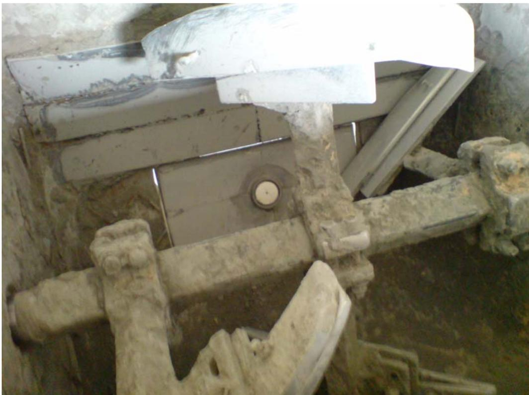
Foto 3 - Exemplo de sonda montada na comporta de descarga de misturador de eixo horizontal. Neste caso também é muito importante a distância entre a face da sonda e a pá do misturador, assim como o paralelismo entre as duas peças.
