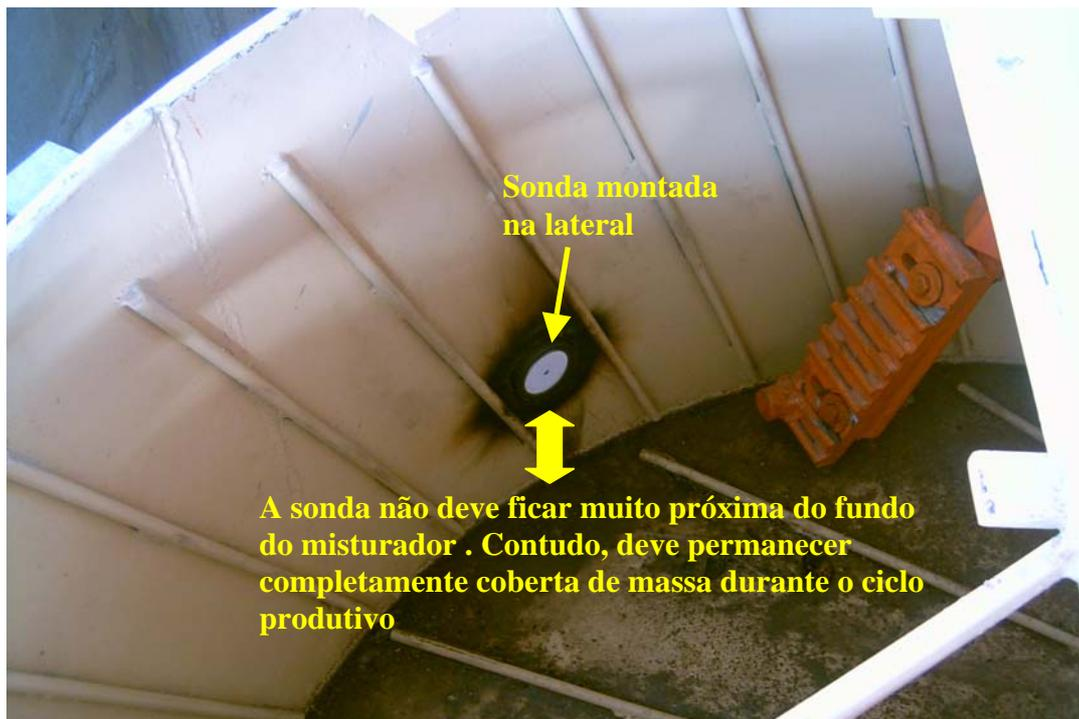
Foto 05 - Vista da sonda montada na parede lateral do misturador.
