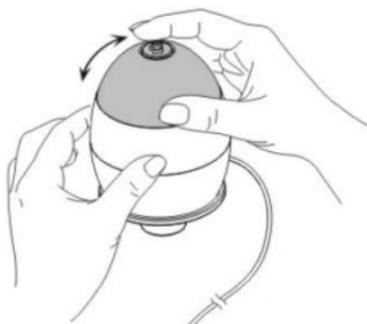
Ajuste o foco da imagem manualmente, girando o anel de foco.
