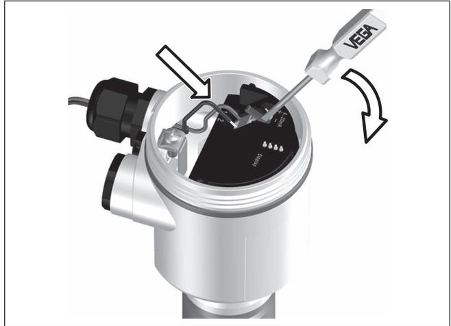
Fig. 33: Passos 6 e 7 do procedimento de conexão
