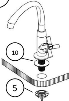
Retire a porca de fixação (5) da torneira, após monte a torneira no local desejado de modo que a vedação (10) fique entre a torneira e o balcão, conforme imagem ao lado, em seguida rosqueie novamente a porca de fixação (5) da torneira.
