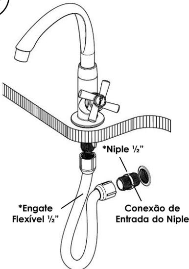
Aplique fita veda rosca na região de conexão de entrada do niple e instale o mesmo no ponto de conexão hidráulica rosqueando até que se obtenha o aperto necessário para assegurar a vedação.
