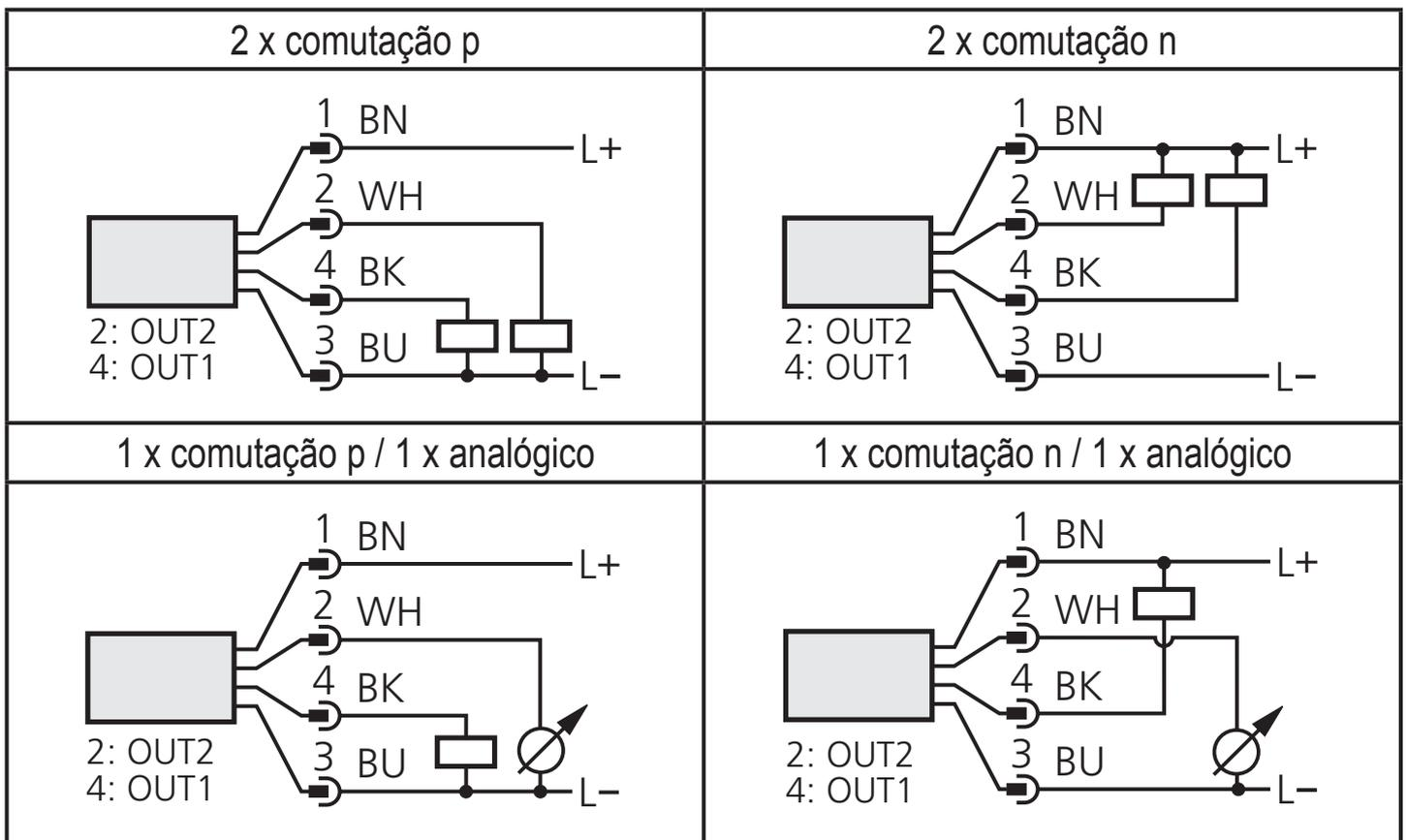
Pin 4 (OUT1) = canal de dados para comunicação bidirecional. Atenção: Não pode ser utilizado para saídas com comutação n.
